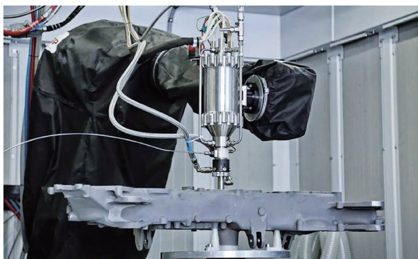
图 4 机器人辅助的冷喷涂技术应用于飞机零件修复
