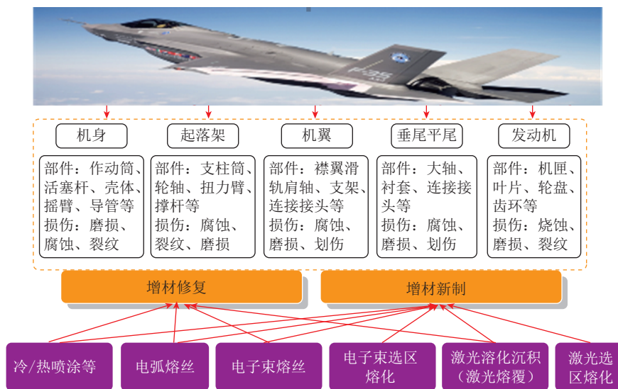
图2 不同部位零件损伤形式及维修工艺
